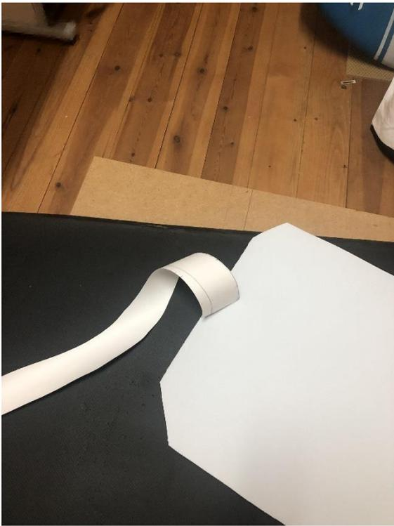
1. На доске с помощью установленной мачты определить оптимальную форму, контролировать пятно контакта, прикладывая к доске. Форму рисовать на бумаги, предварительно зафиксированной скотчем.
